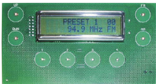
Fot. 1. Przykład wykonania przycisków w postaci odpowiednio zaprojektowanych pól na płytce drukowanej
