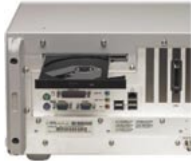
Fot. 4. Tylna część obudowy DSO8000 mocno przypomina PC z zainstalowanym CD-ROM-em
