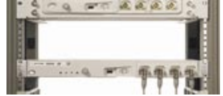
Fot. 6. Oscylloskop z rodziny DSO6000L zainstalowany w racku 19”
