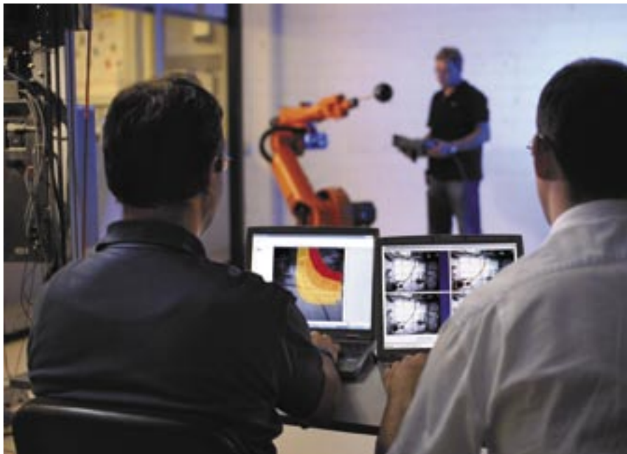
Fot. 2. Programowanie stref roboczych SafetyEYE
