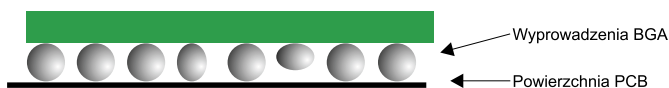
Rys. 1. Różnice wysokości wyprowadzeń BGA mogą prowadzić do utraty styku z polem lutowniczym na płytce drukowanej
