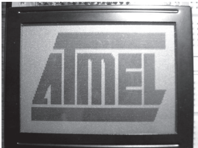
Fot. 9. Efekt działania funkcji lcdBitmap
