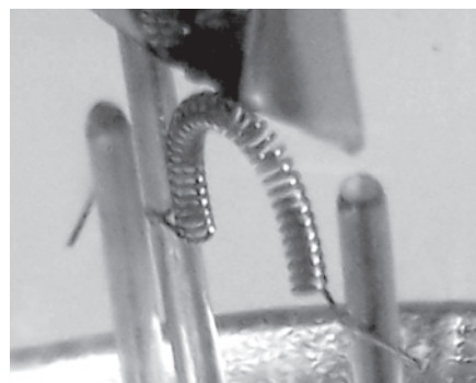
Fot. 1. Zdjęcie systemu elektrodowego gotowej do pracy diody DT1
