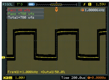
Rys. 4. Oscylogram otrzymany przy włączonej funkcji Pass/Fail
