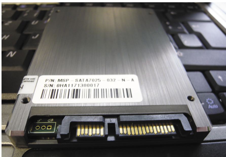
Fot. 2. Dysk 32GB SSD z interfejsem SATA w obudowie aluminiowej
