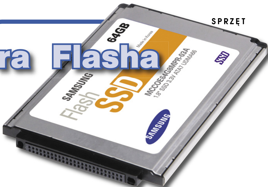
Fot. 1. SSD o pojemności 64 GB w obudowie 1,8"
