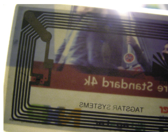
Fot. 2. Podświetlona etykieta z uwidocznionymi elementami transpondera
