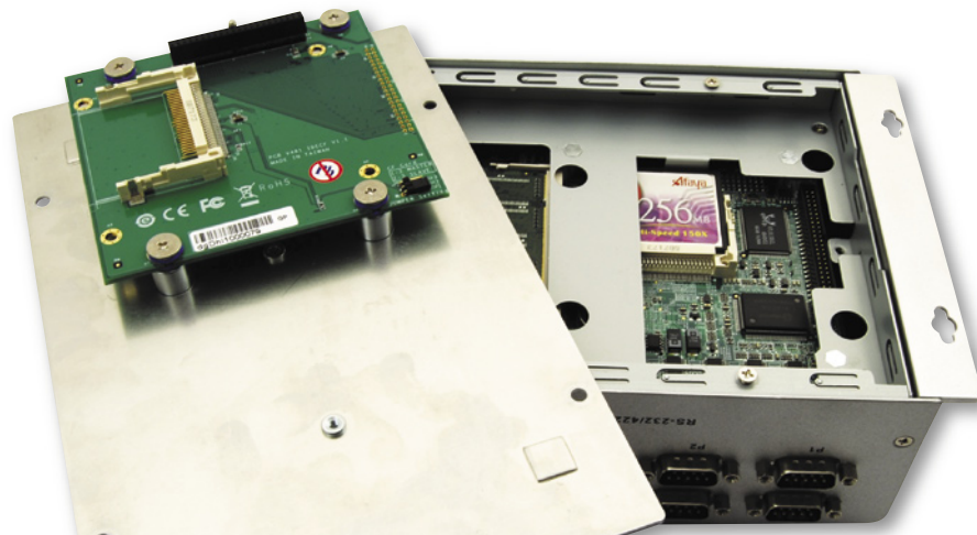
Fot. 1. Instalacja dodatkowej karty Compact Flash
