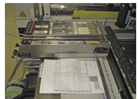
Fot. 7. Uzbrojone podajniki w elementy SMD wraz z dokumentacją, gotowe do montażu
