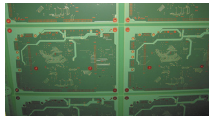
Fot. 5. Formatka PCB po nałożeniu, naświetleniu i wywołaniu maski przeciwlutowej
