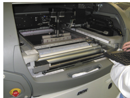
Fot. 6. Pierwszy etap montażu SMT – nakładanie pasty lutowniczej na sitodrukarce DEK Horizon 03i
