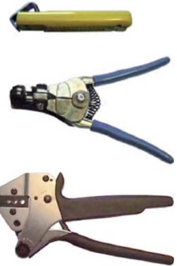
Fot. 7. Narzędzia do obróbki i zaciskania końcówek światłowodów BFOC oraz plastikowych
