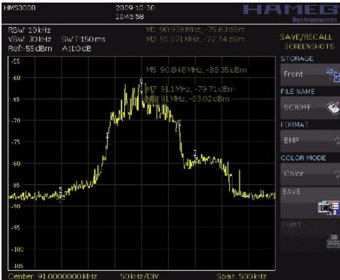
Rys. 5. Wykonywanie pomiarów za pomocą znaczników
