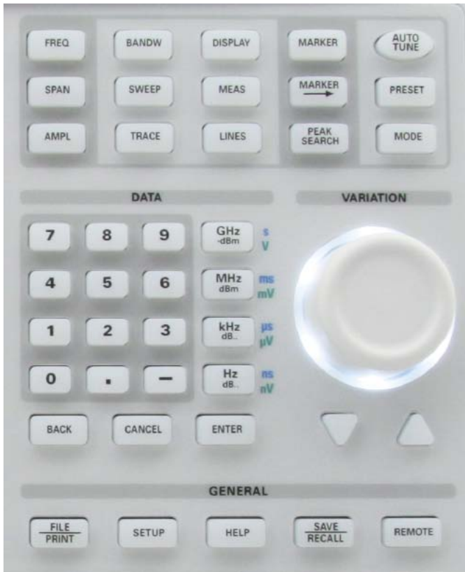
Fot. 2. Panel operatora analizatora widma HMS3010
