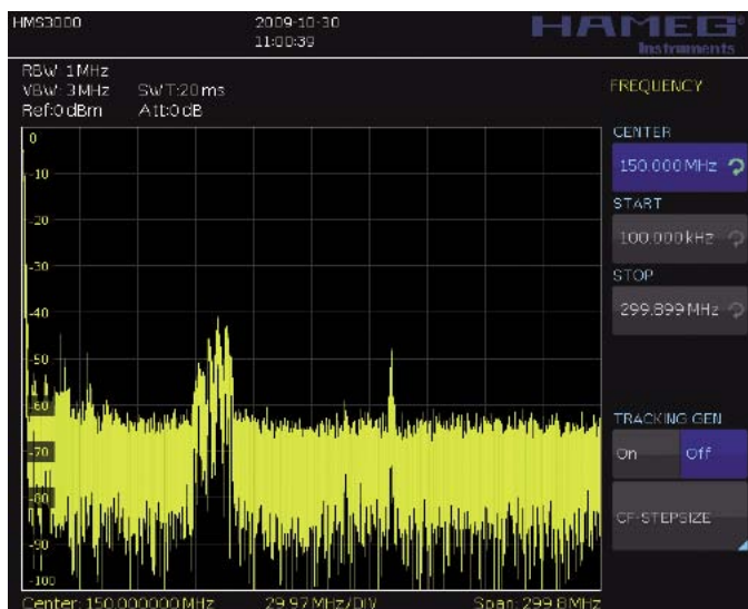
Rys. 1. Widok menu zmiany nastaw częstotliwości
