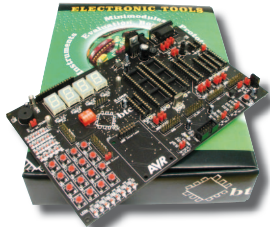
Fot. 3. Zestaw ZL10AVR (obsługuje blisko 30 typów mikrokontrolerów AVR)
