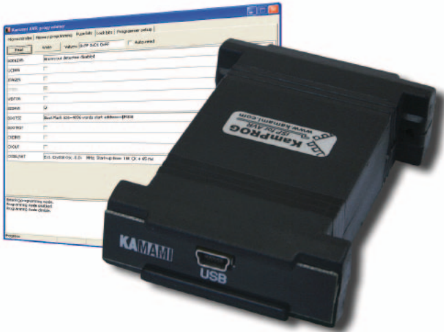
Fot. 5. Programator KamPROG AVR oraz okno programu służącego do jego obsługi
