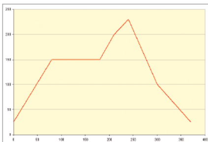
Rys. 4. Przykładowy profil temperaturowy stosowany podczas montażu SMD
