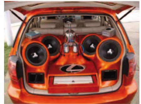
Fot. 11. Wzmacniacz dużej mocy z zestawem głośnikowym
