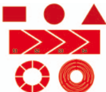
Rys. 1. Przykładowe kształty pól czujnikowych „przycisków” dotykowych
