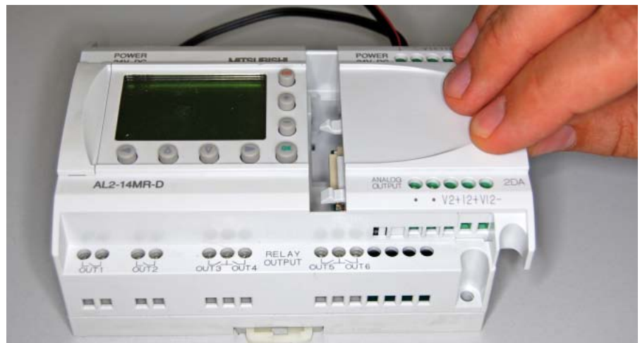
Fot. 3. Sposób podłączenia dodatkowego modułu wyjść analogowych
