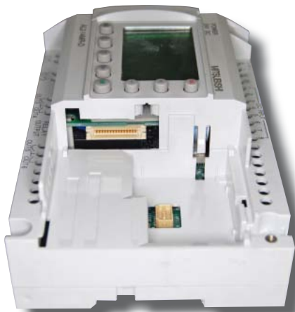
Fot. 2. Sposób umieszczenia gniazda modułów rozszerzeń
