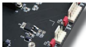
Fot. 4. Specjalne złącza SPI i I 2 C umożliwiają dołączanie m.in. szerokiej gamy modułów peryferyjnych z serii KAmoD
