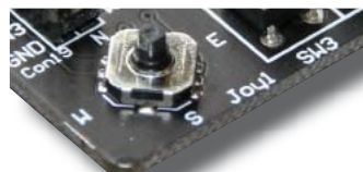
Fot. 2. Standardowym elementem wyposażenia zestawu ZL30ARM jest 5-pozycyjny joystick
