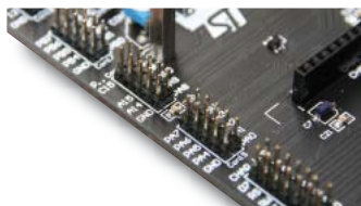
Fot. 3. Linie I/O mikrokontrolera w zestawie ZL30ARM wyprowadzono na gold-piny, umożliwiające dołączanie elementów zewnętrznych za pomocą przewodów ze sprężystymi końcówkami
