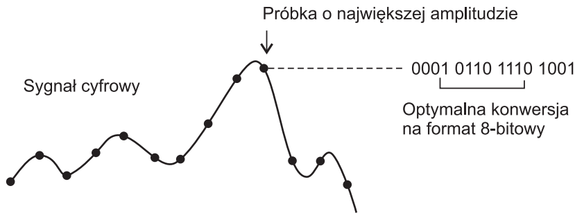
Rys. 18. Sposób ustalania rozdzielczości z zachowaniem maksymalnej dynamiki
