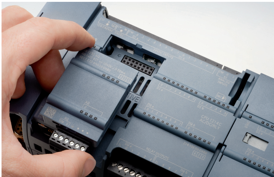
Rys. 2. Umieszczenie płytki sygnałowej na jednostce centralnej
