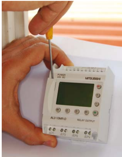
Fot. 16. Usunięcie zaślepki gniazda
