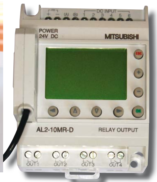
Fot. 17. Podłączenie kabla do programowania sterownika
