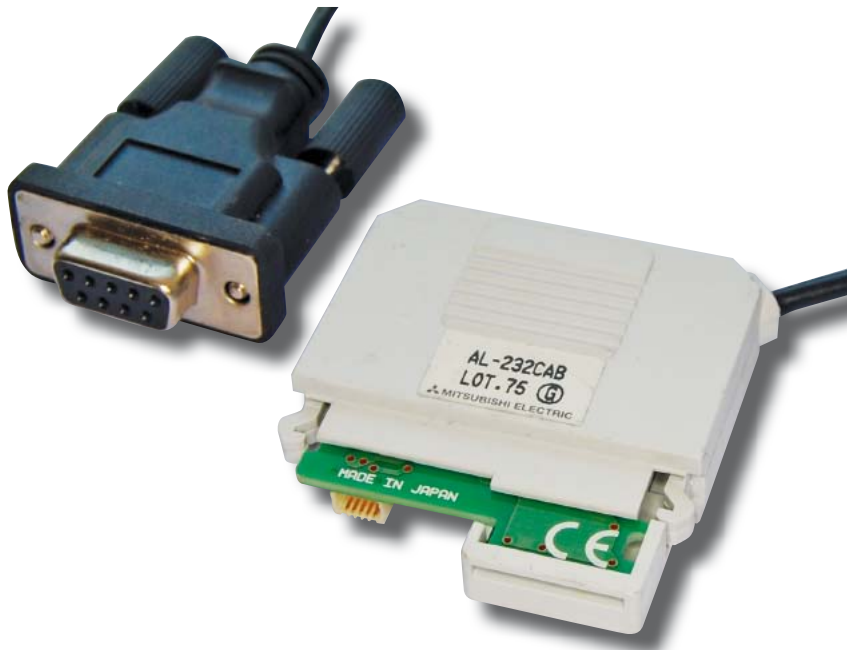
Fot. 2. Kabel AL-232CAB do programowania sterownika
