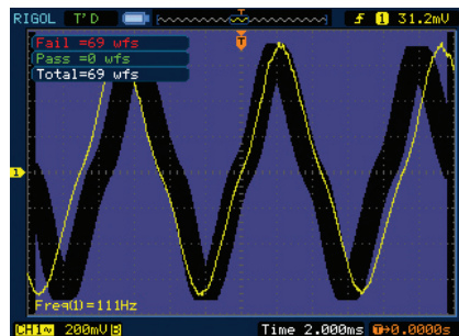
Rys. 8. Przekroczenie pola tolerancji w teście Pass/Fail
