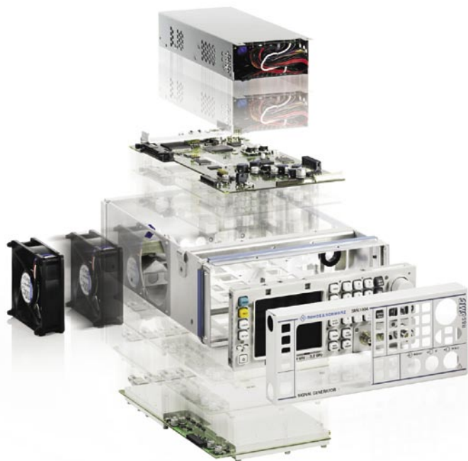
Rys. 1. Modułowa budowa generatora R&amp;S SMC100A
