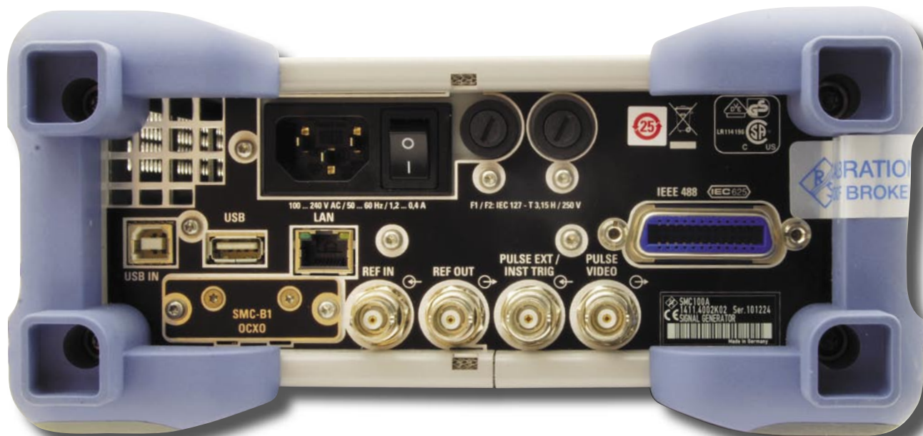
Fot. 8. Widok tylnej ścianki generatora R&S SMC100A
