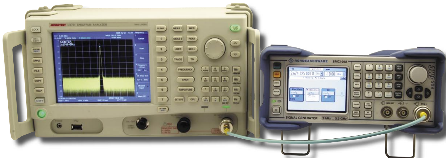
Fot. 2. Stanowisko pomiarowe z generatorem R&amp;S SMC100A i analizatorem widma Advantest U3751
