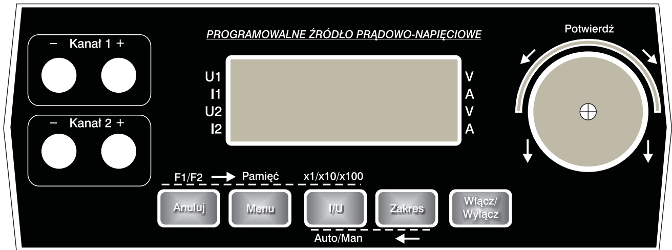
Rys. 12. Propozycja wykonania płyty czołowej
