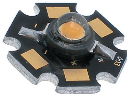
Fot. 2. Emiter LED zamontowany na miniaturowym radiatorze
