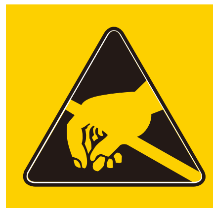
Podstawowy symbol składa się z żółtej dłoni na czarnym trójkącie. Tak jest oznaczany sprzęt wrażliwy na rozładowania ESD
