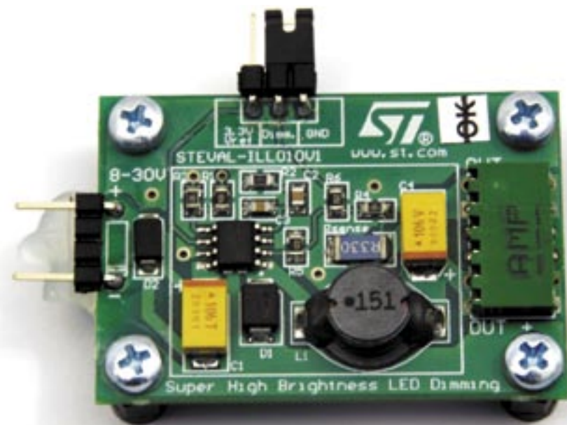
Fot. 2. Układ L6902 wymaga zastosowania niewielkiej liczby podzespołów
