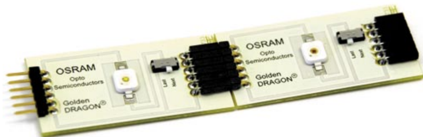
Fot. 6. Wygląd zastosowanych w zestawie LED mocy LW W5SG z serii Golden Dragon firmy Osram
