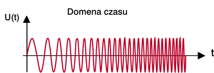
Rys. 1. Liniowa modulacja częstotliwości nośnej (LFM – Linear Frequency Modulation)
