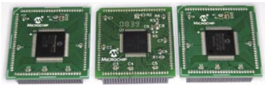
Fot. 2. Moduły PIM (Plug-In Module) z mikrokontrolerami PIC
