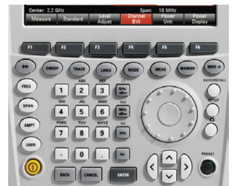
Rys. 1. Widok klawiatury analizatora widma FSH8
