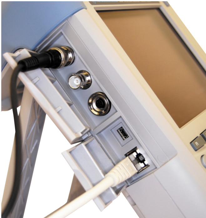
Fot. 3. Złącza komunikacyjne i sygnałowe
