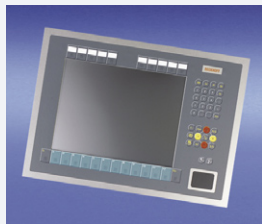
Z klawiaturą numeryczną i 10 przyciskami PLC
