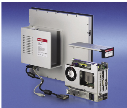
Fot. 5. Wyjęta z obudowy jednostka centralna CP63xx
