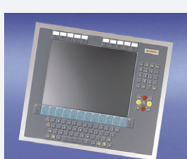
Z klawiaturą standardową i 10 przyciskami PLC
