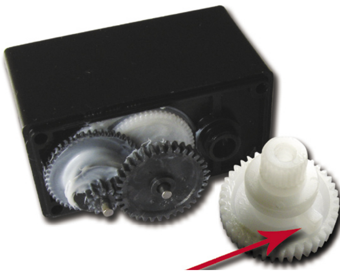
Fot. 3. Przeróbka serwomechanizmu – usunięcie blokady na zębatce
