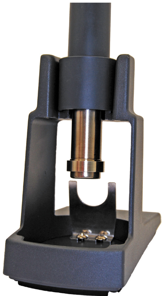
Fot. 3. Szczelina służąca do wyjmowania dyszki z kolby
