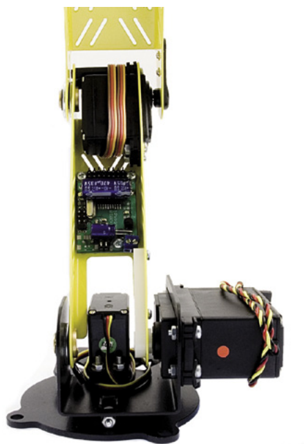
Rysunek 3. Miejsce zamocowania płytki kontrolera serwomechanizmów
