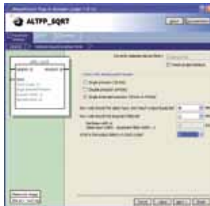
Rysunek 3. Drugie okno kreatora umożliwia wybór formatu danych wejściowych i wyjściowych oraz liczby taktów opóźnienia generowania wyniku (jak na rysunku 4)
