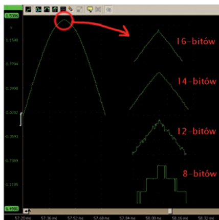
Rysunek 3. Efekt próbkowania przebiegów z różnymi rozdzielczościami dostępnymi w HS3
