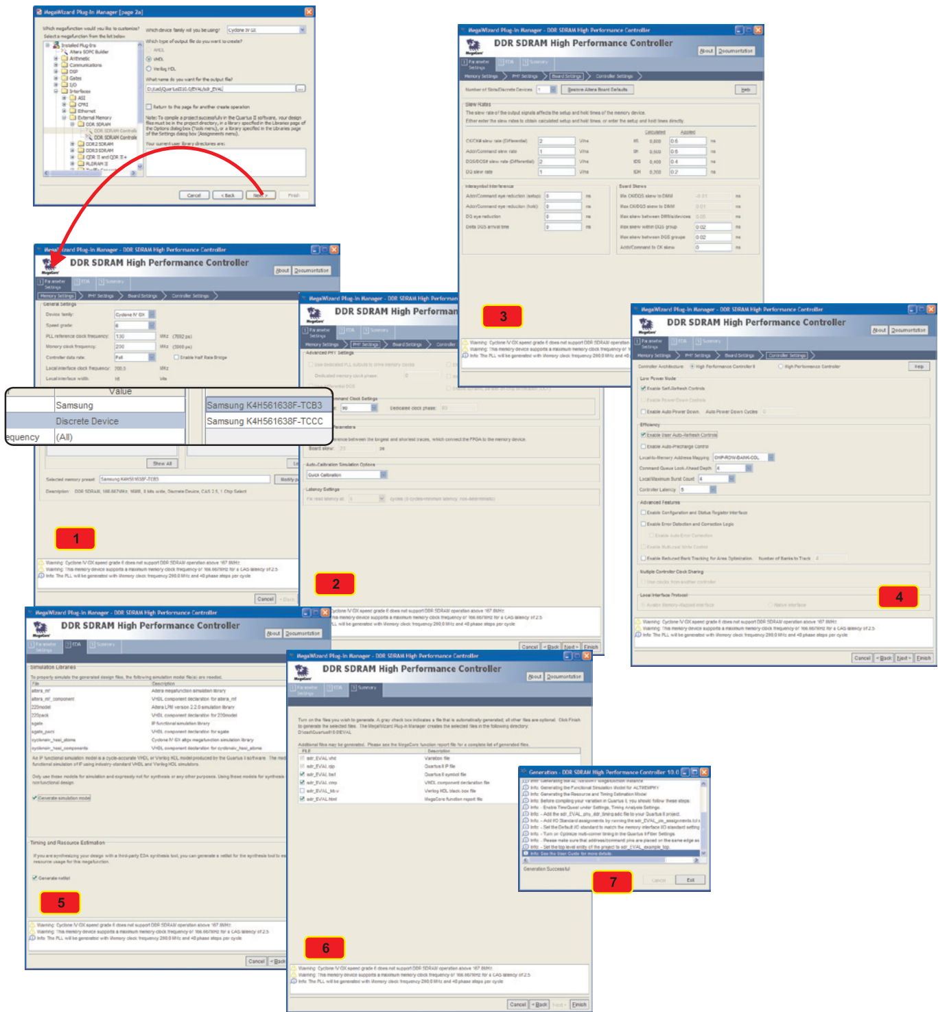
Rysunek 5. Przebieg kreacji interfejsu pamięci SDRAM DDR, kolejne etapy oznaczono cyframi
