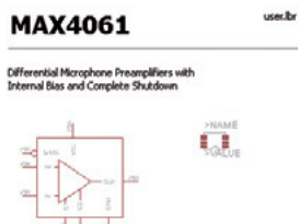
Rysunek 20. Podgląd gotowej definicji komponentu w Eagle
