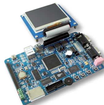
Fotografia 6. Zestaw Embest EM-LPC2478B wyposażono w pamięci: 64 MB NAND Flash, 32MB SDRAM oraz 2 MB NOR Flash, a także w (między innymi) coraz powszechniejszy w „małych” systemach interfejs Ethernet
