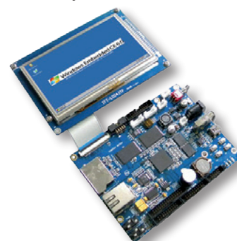
Fotografia 7. Nowość w ofercie KAMAMI.pl – zestaw Embest SAM9G45, wyposażono m.in. w 128 MB SDRAM i 256 MB Flash SLC
