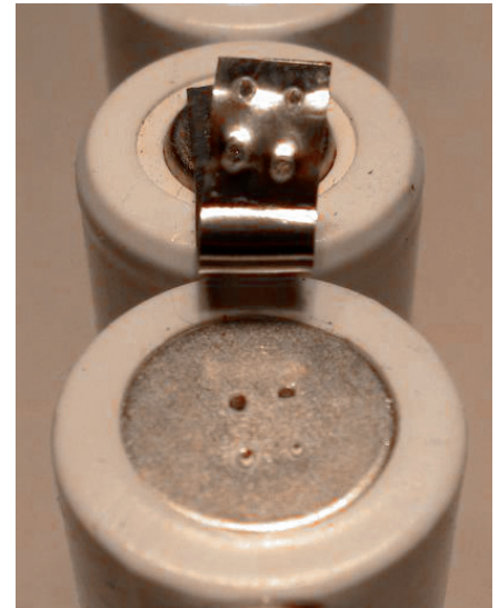
Fotografia 25. Badanie niszczące złącza zgrzewanego
