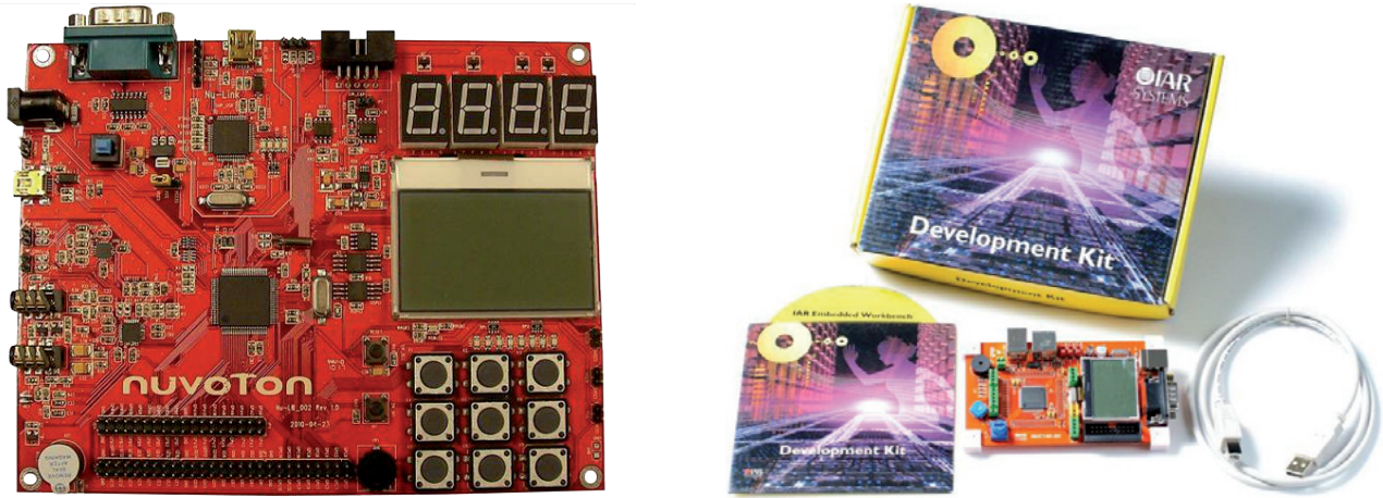
Rysunek 2. Przykładowy zestaw ewaluacyjny z mikrokontrolerem NuMicro
