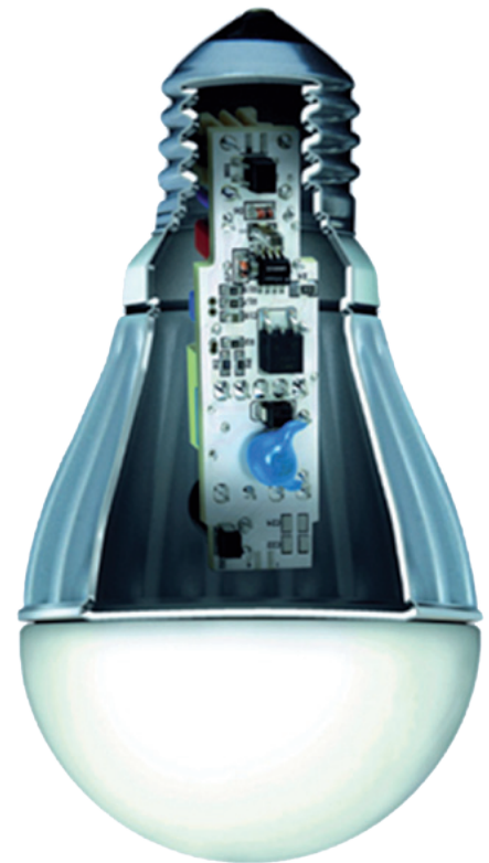
Rysunek 12. Fizyczna realizacja zamiennika żarówki z gwintem E27 [1]
