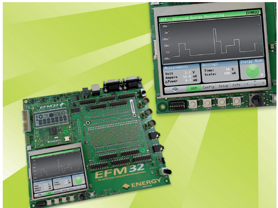
Fotografia 4. Zestaw uruchomieniowy EFM32 Gecko Development Kit z mikrokontrolerem EFM32G890F128. Dane wyświetlane na reklamowej wersji zdjęcia wyświetlacza monitora poboru energii są bardzo optymistyczne...
