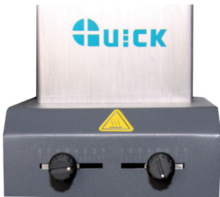
Fotografia 6. Mechaniczna przestłona wiązki podczerwieni górnego grzejnika
