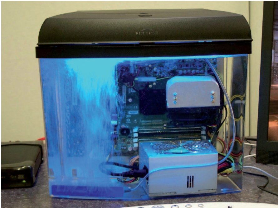
Fotografia 1. Dzieło firmy Puget Systems – PeCet zanurzony w chłodzącym go oleju transformatorowym
