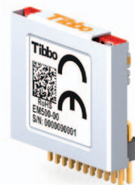
Rysunek 4. Wszystkie linie modułu EM500 wyprowadzono na 22-stykowe, dwurzędowe złącze szpilkowe
