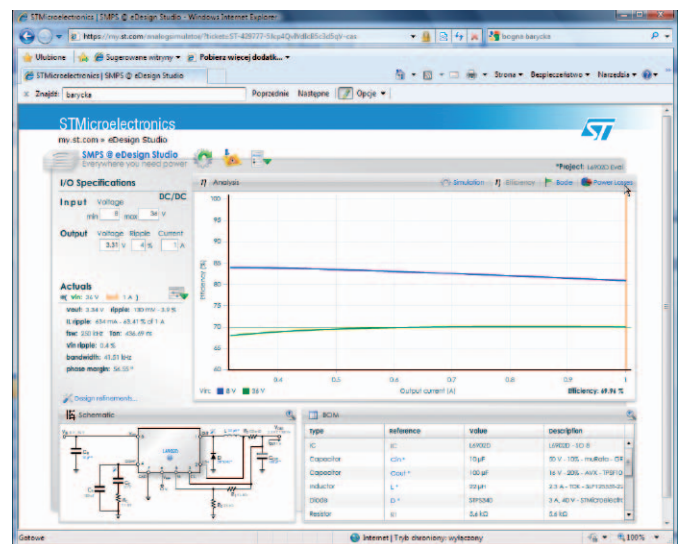
Rys. 7. Wykresy sprawności energetycznej przetwornicy
