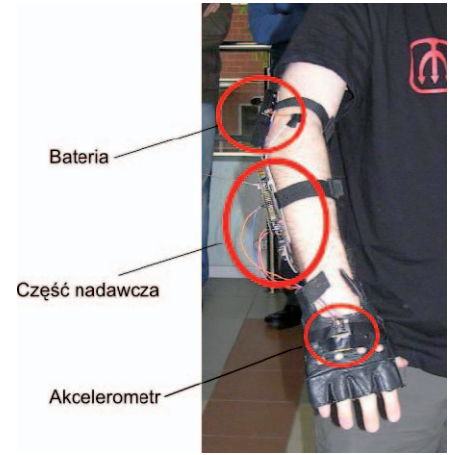
Rys. 2. Sugerowane umiejscowienie elementów części nadawczej
